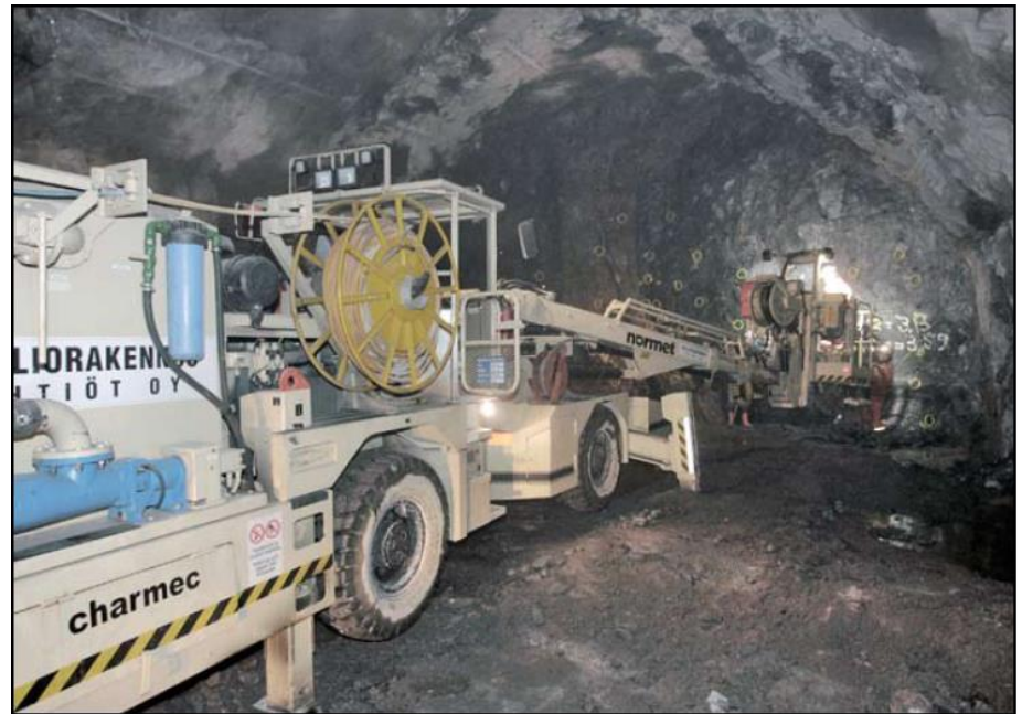
Emulsiopanostusajoneuvo Normet Charmec 98 panostustyössä
